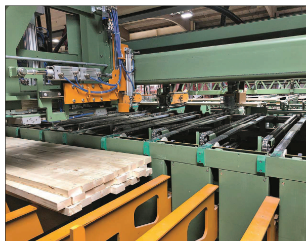
Das neue Trockensortierwerk des Herstellers Kalfass ist Teil eines Investitionspakets, das mehr Automation und eine Erhöhung der Produktionskapazität erlaubt.
