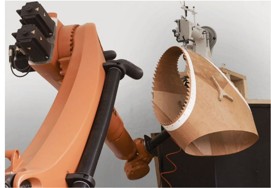
Das genähte Holztragwerk im linken Bild ist die Weiterentwicklung des Forschungspavillons von 2015/2016. Drei individuell laminierte Sperrholzstreifen wurden für die Entwicklung der Forschungspavillonelemente elastisch gebogen und an ihren Enden vom Roboter zusammengenäht. Fotos: ICD University of Stuttgart (links) ICD ITKE (rechts)
